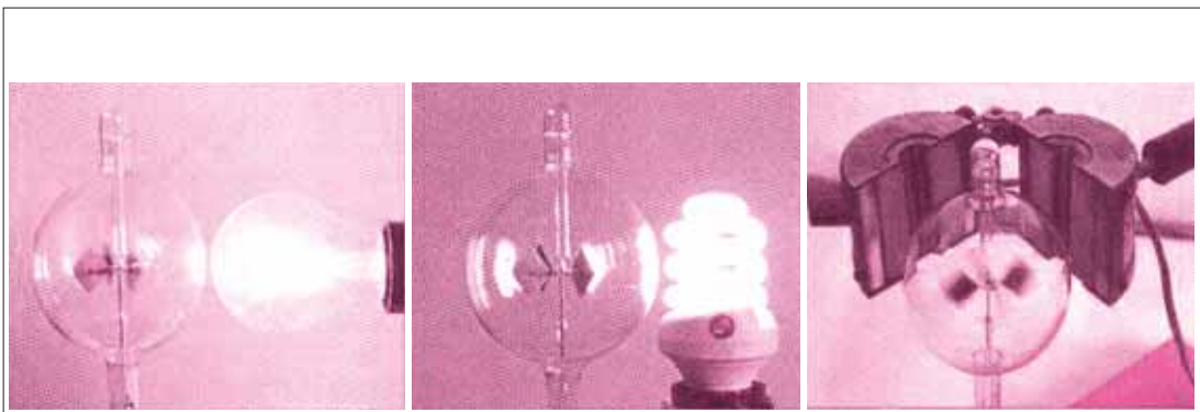
▲ شکل ۱. شکل ۱۰ مقایسه اثر سه منبع امواج الکترومغناطیسی در به چرخش درآوردن پره‌های تابش‌سنج. توان الکتریکی کل لامپ التهابی در حدود ۶۰ وات و توان تابشی کمیته آن ۸۰۰ لومن است، در حالی که توان لامپ فلئورسان فشرده ۱۳ وات و توان تابشی آن ۸۰۰ لومن است. توان کل الکتریکی گرمکن در طرف راست ۶۰ وات است.
